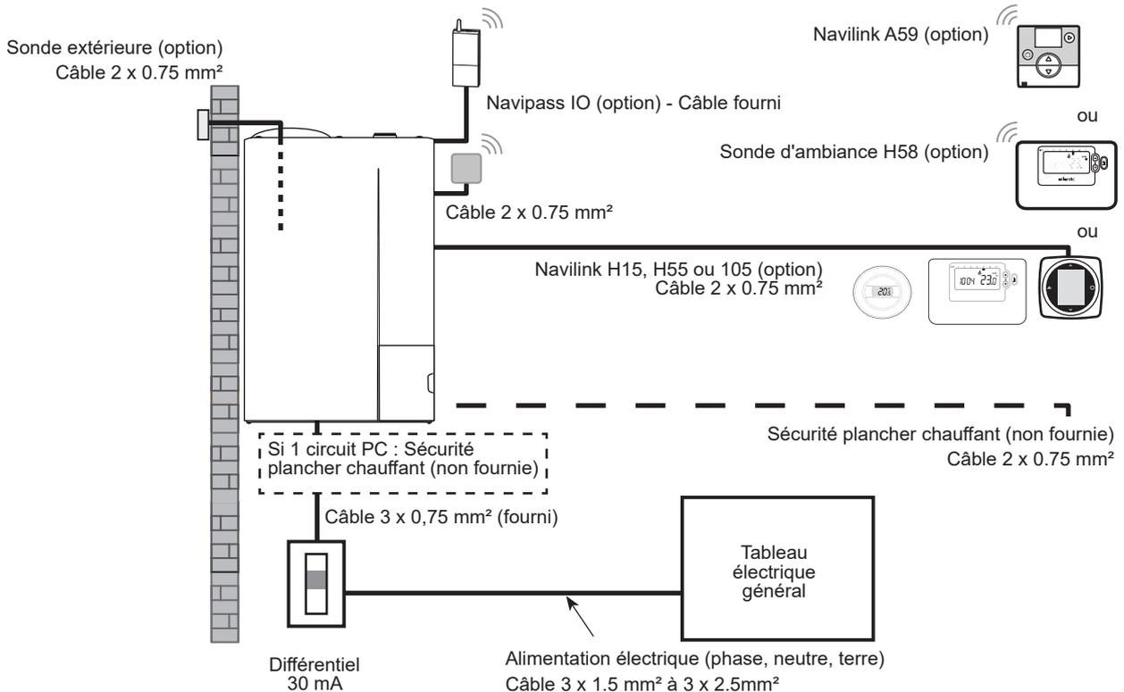
fig. 18 - Schéma d'ensemble des raccordements électriques
