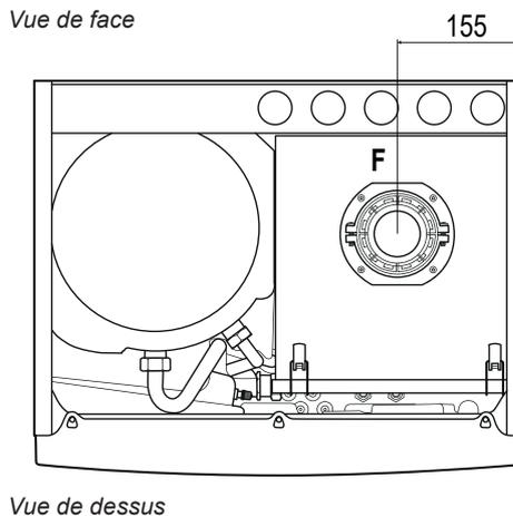
fig. 3 - Dimensions - Chauffage seul ( en mm)
