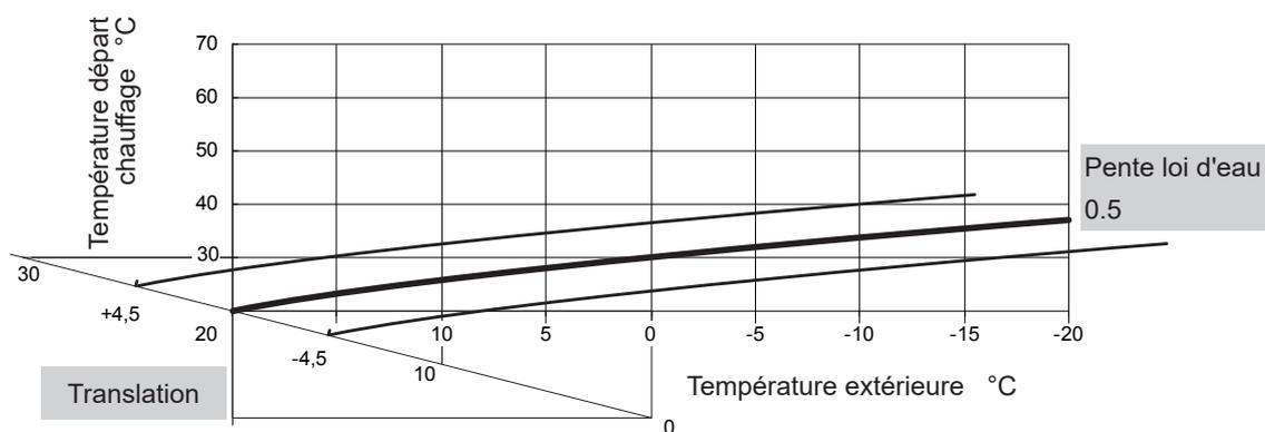
fig. 26 - Translation de la courbe de chauffe (Paramètres 31 / 41)
