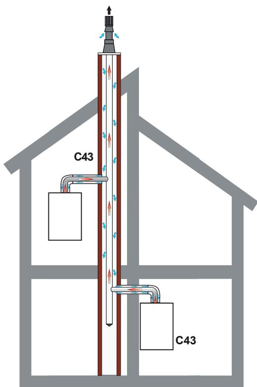
fig. 10 - Possibilités de raccordement (type 43)
