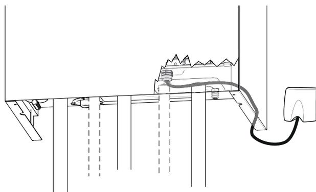
fig. 19 - Alimentation électrique 230 V (50 Hz)
