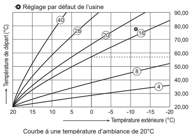
fig. 28 - Courbe de chauffe (Navilink H55)
