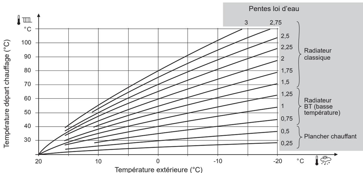
fig. 25 - Pente de la courbe de chauffe (Paramètres 30 / 40)
